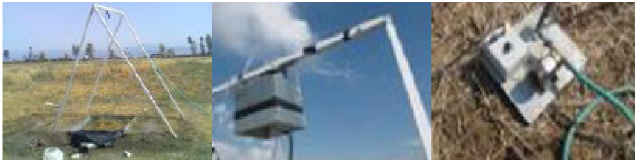
شکل ۱- شبیه‌ساز باران قابل حمل مدل Delta lab Eid۳۳۰
