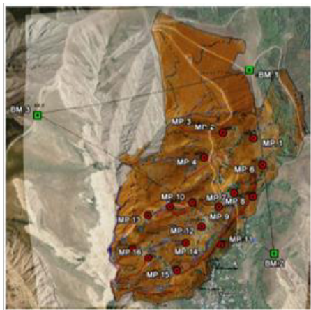
شکل ۳- موقعیت ایستگاه‌های مبنا و شاهد برای پایش منطقه‌ی لغزشی.
