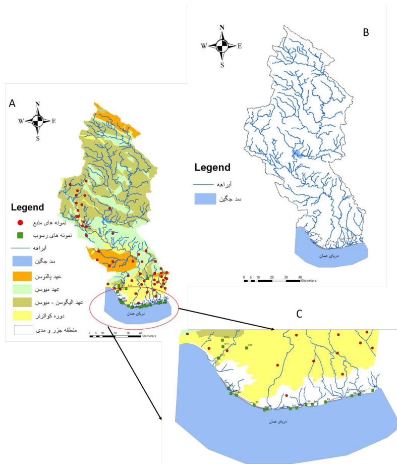
شکل ۱- منطقه‌ی بررسی: (A) نقشه‌ی زمین‌شناسی، نقاط نمونه‌برداری منابع و رسوب؛ (B) نقشه‌ی شبکه‌ی هیدروگرافی و موقعیت سد جگین؛ و (C) نقاط نمونه‌برداری از منطقه‌ی رسوب.
