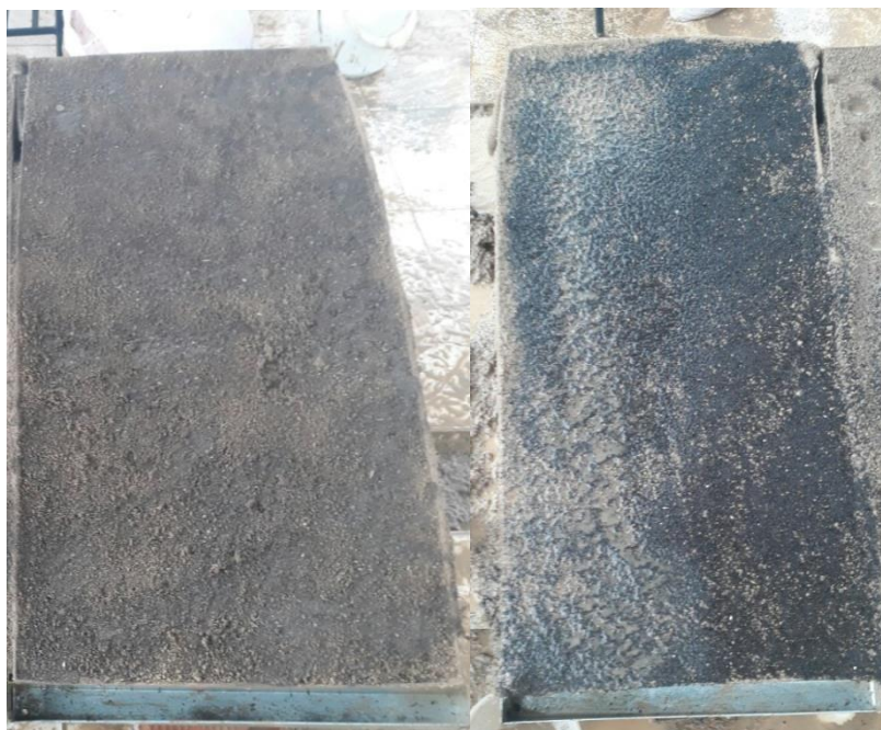
شکل ۱- کرت‌های آزمایشگاهی در قبل (راست) و بعد (چپ) از کاربرد کمپوست در شرایط شبیه‌سازی باران با شیب ۲۰ درصد.
