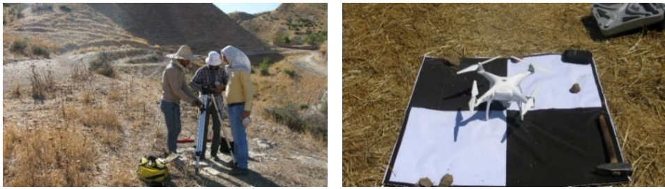
شکل ۶- تصویری از علامت گذاری نقطه‌ها و خواندن با دستگاه موقعیت یاب جهانی دو فرکانسی.
