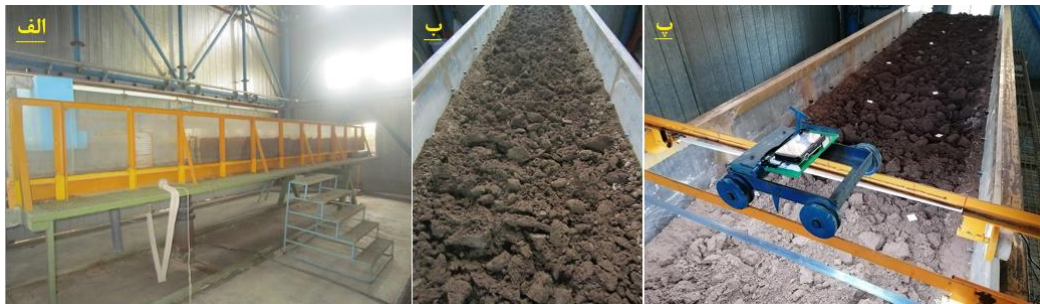
شکل ۱- الف: نهر پایه‌دار آزمایشگاهی، ب: خاک شخم‌خورده، پ: ارباهی عکس‌برداری در نهر پایه‌دار آزمایشگاهی.
