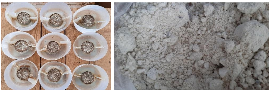
شکل ۲- نمایی از بنتونیت استفاده شده (راست) و کاربرد اندازه های گوناگون آن روی سطح خاک در فنجان های پاشمان (چپ).
