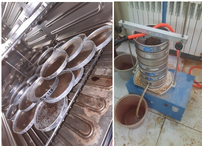
شکل ۳- دانه‌بندی خاک دانه‌های خاک با روش الک تر (راست) و نمونه‌های جمع‌آوری شده به تفکیک هر الک (سمت چپ).
