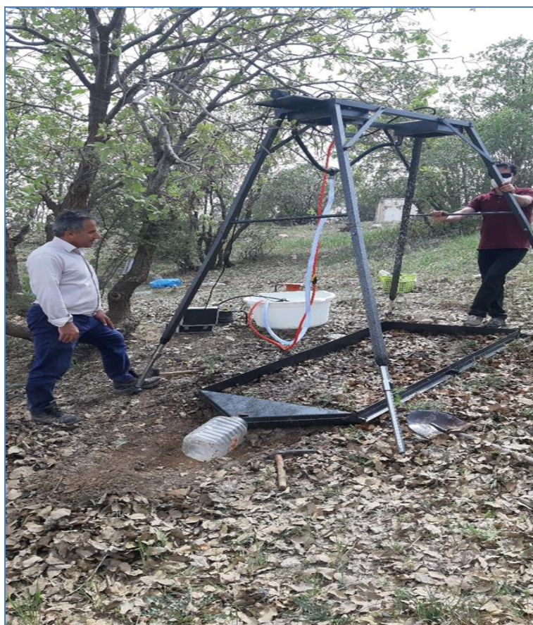
شکل ۲- دستگاه شبیه‌ساز باران و شیوه جمع‌آوری نمونه رواناب و رسوب.
