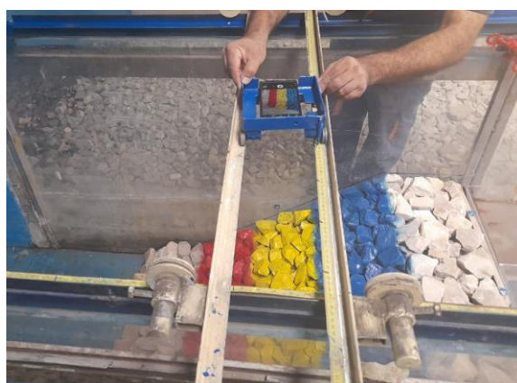
شکل ۲- فتوگرامتری مدل فیزیکی سازه حفاظتی بندر گناوه قبل و بعد از آزمایش‌ها.
