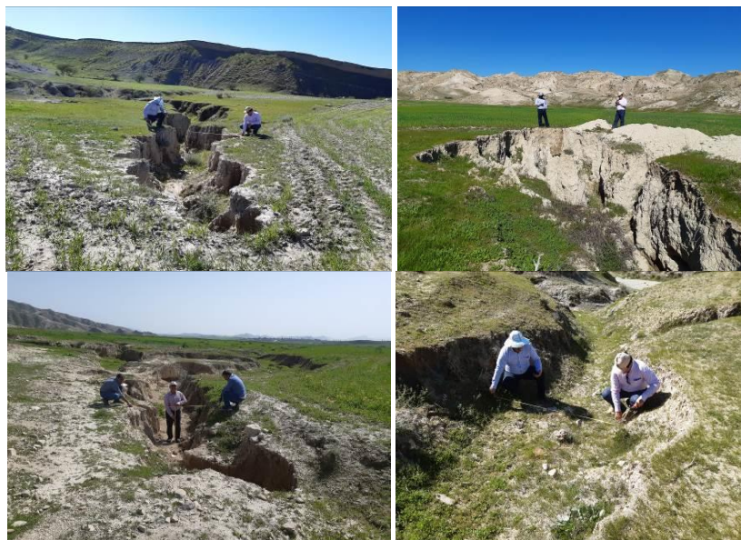
شکل ۲- اندازه‌گیری‌های میدانی خندق‌های مطالعه‌شده (به ترتیب از راست به چپ: ثبت موقعیت جغرافیایی خندق‌ها با استفاده از دستگاه GPS، اندازه‌گیری عرض بالا، عرض پایین و ژرفای خندق‌ها).
