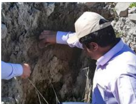
شکل ۳- نمونه‌برداری خاک از پیشانی خندق به وسیله استوانه فلزی استاندارد.
